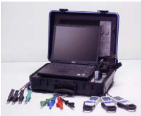
Por outro lado, a utilização de coletores de dados de vibração, possuidores de processadores FFT e equipados com acessórios de avaliação da condição elétrica como Alicates Amperímetro e
