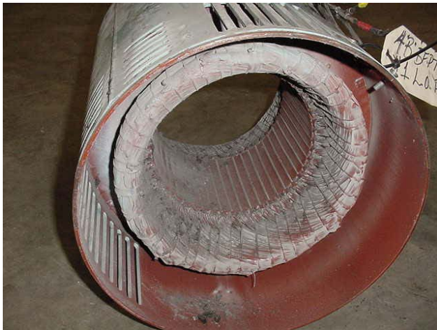
Figura 10 - Estator del motor que con el sistema de aislamiento contaminado.
